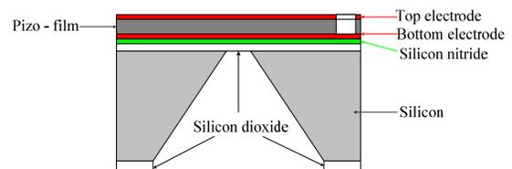
Fig. 1. Diagram of FBAR.
