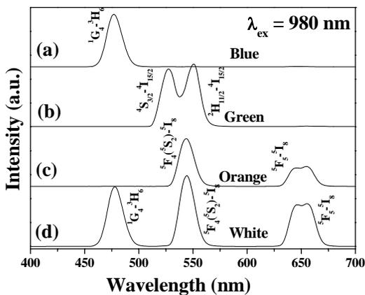
Fig. 3. UC luminescence spectra of Na<sub>0.5</sub>Gd<sub>0.5</sub>WO<sub>4</sub> nanocrystals doped with 10%Yb<sup>3+</sup>/1%Tm<sup>3+</sup> (a), 10%Yb<sup>3+</sup>/1%Er<sup>3+</sup> (b), 10%Yb<sup>3+</sup>/1%Ho<sup>3+</sup> (c), and 10%Yb<sup>3+</sup>/1%Tm<sup>3+</sup>/0.4%Ho<sup>3+</sup> (d) under 980 nm semiconductor laser excitation.
