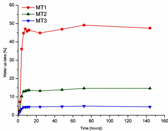
Fig. 6. Water absorption for the collagen:Mg +  $\beta$ -TCP composites.
